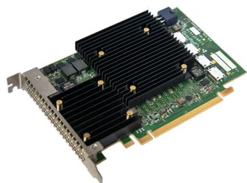
LightField 是一种PCIe存储加速附加卡（AIC），它可增强存储资源的性能、效率和利用率。LightField 与 LightOS 无缝集成，并提供基于硬件的高效内联数据路径设计，该设计可提高系统吞吐量，SSD 利用率和耐用性。
